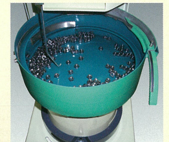
■ナット選別用ボウル (ボウル径φ300) *φ300ボウルは裏ナット回収機構付です Nuts selection bowl (Bowl diameter 300mm) *300mm diameter bowl has the mechanism collecting the back nuts.
